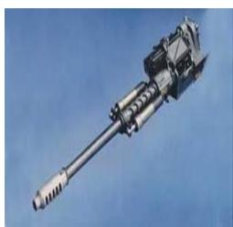
**Вертолет вооружен 30-мм пушкой, аналогичной пушке БМП-2. Она имеет два темпа стрельбы — 800 и 300 снарядов в минуту. Снаряды унифицированы с сухопутными. Кроме пушки, на внешних подвесках Ми-28 может уместится целый арсенал - от блоков НУРС до управляемых ракет. Предусмотрено и приспособление для постановки мин.**
